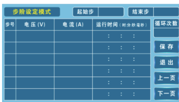
步阶设置页面可设置所需电压、电流运行时间、初始步、结束步和循环次数
